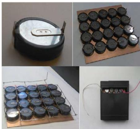
Рисунок 4 – Блок суперконденсаторов емкостью 40Ф
