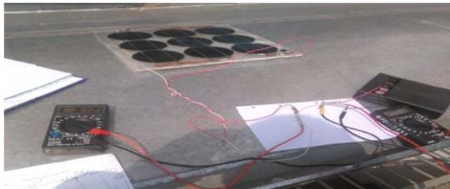
Рисунок 7 – Эксперимент по снятию зарядной характеристики суперконденсаторов в натуральных условиях
