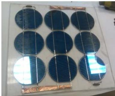
Рисунок 5 – Экспериментальный солнечный модуль
