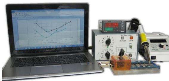
Рисунок 2 – Рабочее место исследования пайки соединений с токовой активацией
