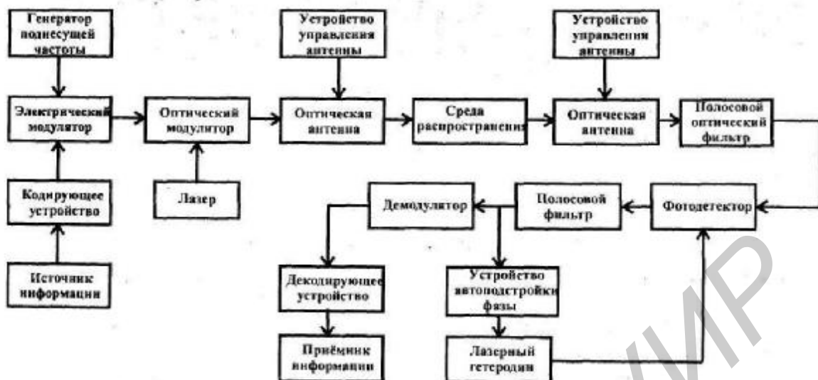
Рис. 1.24. Обобщенная структурная схема оптической системы связи.
