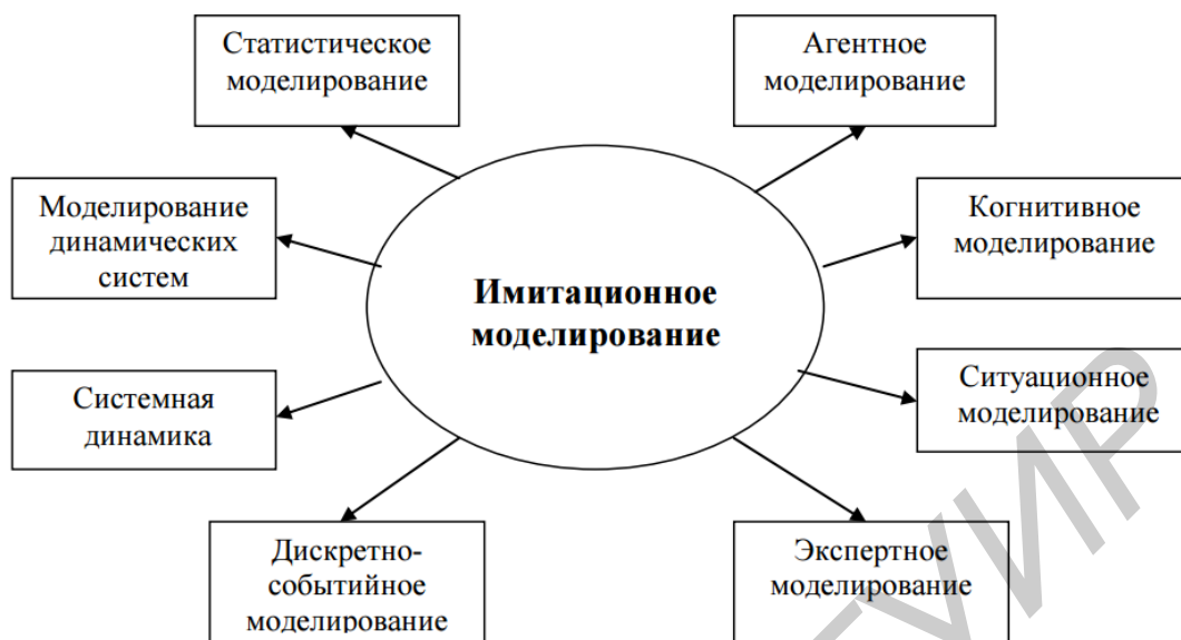
Рисунок 3 – Разновидности имитационного моделирования
