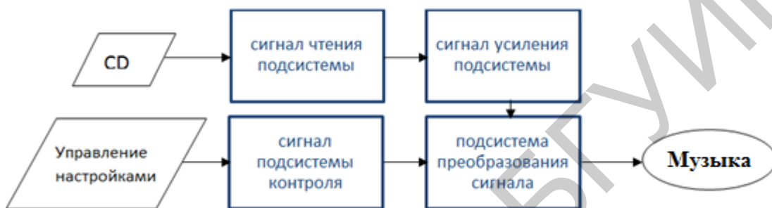
Рисунок 2.2 – Декомпозиция системы CD-плеера
