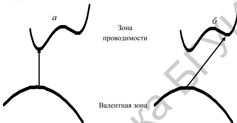
Рисунок 3.2 – Прямой (а) и непрямой (б) межзонные переходы
