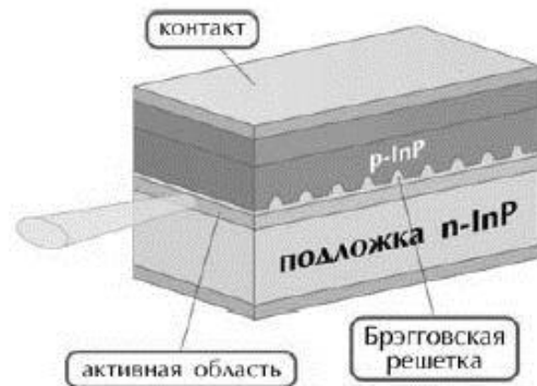
Рисунок 3.35 – Полупроводниковый лазер с распределенной обратной связью
