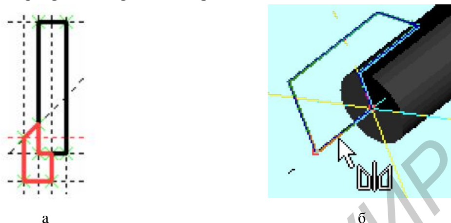
Рис. 3.8. Двумерное построение пластмассового резьбового соединения (а) и его 3D модели (б)
