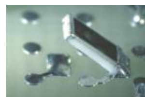
Дефект «надгробный камень»
