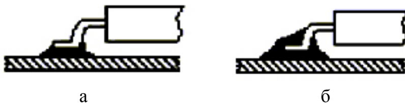
Рис. 4.6. Виды паяных соединений SMD: а – надежное, б – ненадежное
