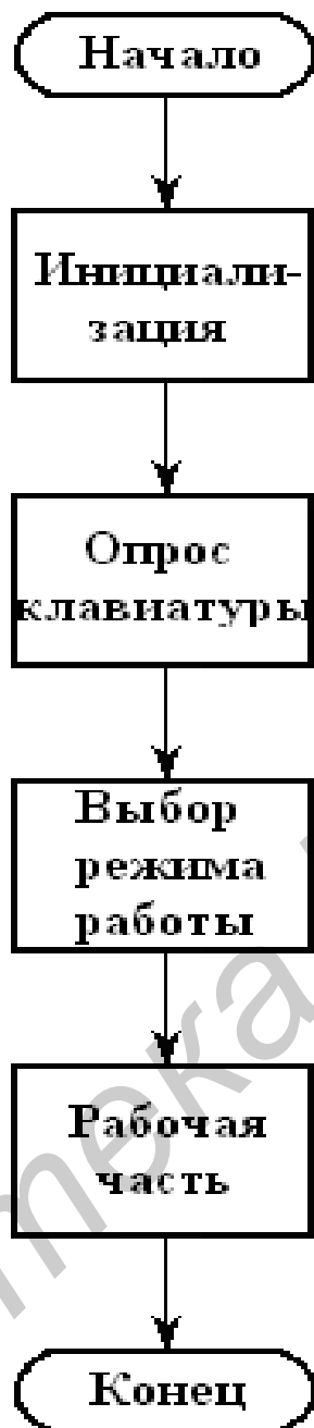
Рисунок 5.5 – Пример концептуального алгоритма работы микроконтроллера в терапевтическом устройстве
