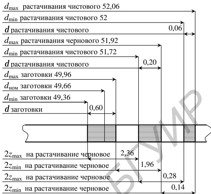
Рис. 7.2. Схема расположения припусков и допусков на обработку отверстия корпуса подшипника
