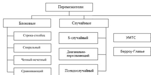
Рис. 1 – Классификация устройств перемежения
