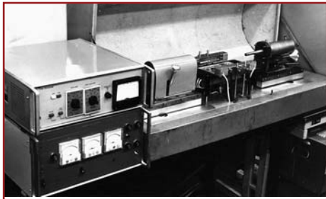
Рис. 4. Установка УЗ пайки микроплат
