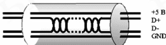
Рисунок 1.7 – Изображение кабеля USB в разрезе
