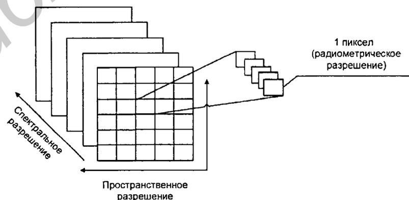
Рис. 1. Структура данных дистанционного зондирования Земли
