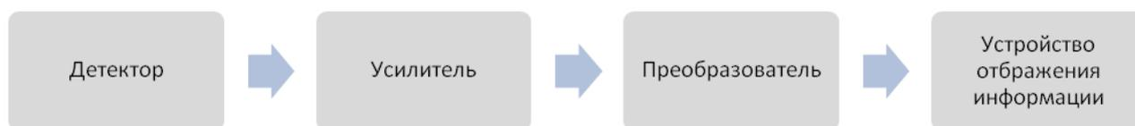
Рис. 12. Структурная схема датчика радиоактивности
