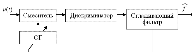
Рис. 1. Структурная схема ССН
