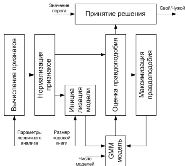
Рис. 1. Структура системы верификации диктора по произвольной речи
