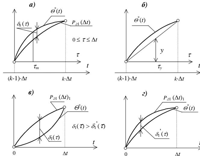
Рис. 2. Величина интервальной погрешности: *a* — в общем случае; *б* — при замене функции стягивающей ее хордой; *в* — для вогнутых функций; *з* — для выпуклых функций
