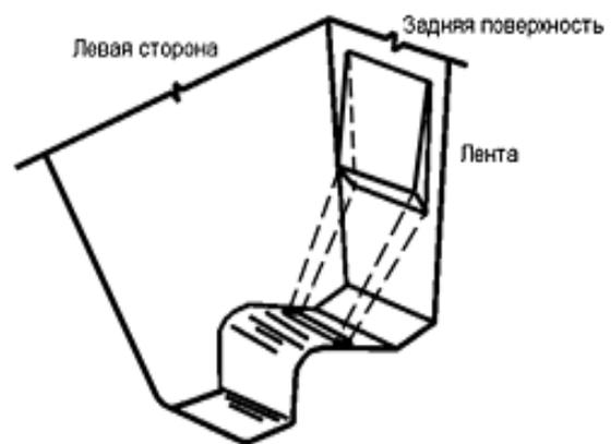
**Рис.4.** Инструмент для микросварки ленточных перемычек
