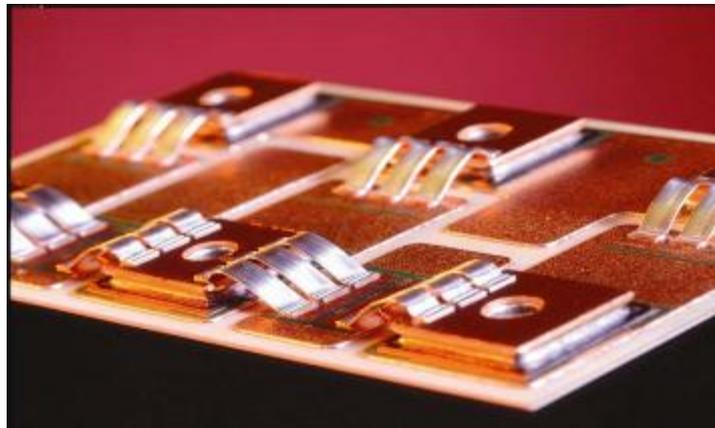
**Рис.2.** Соединения в силовых приборах с помощью ленточных переемычек
