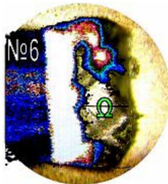
**Рис. 10.** Внешний вид некачественного микросварного соединения №6 и соответствующая ему лазерная фотоакустическая топограмма
