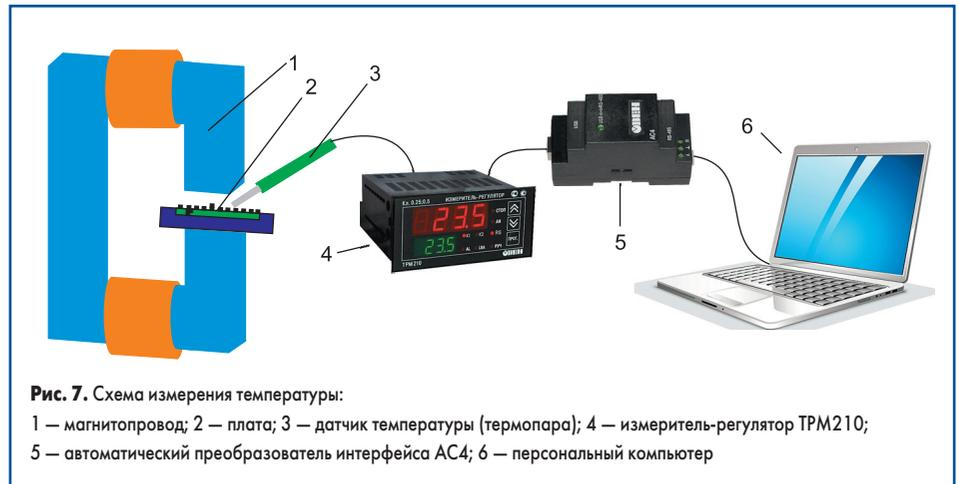
**Рис. 7.** Схема измерения температуры:
