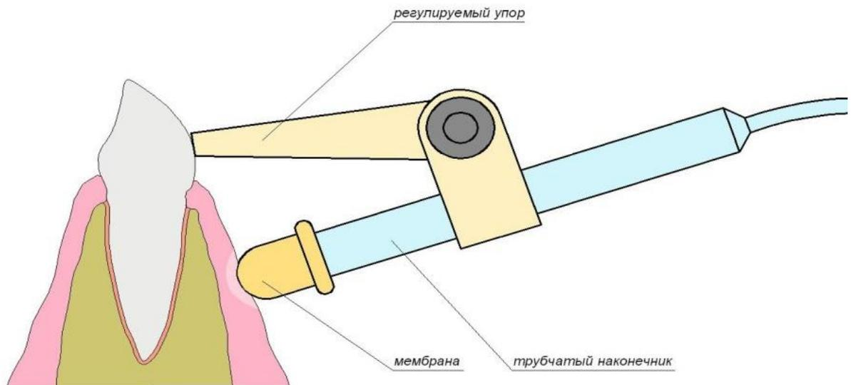
**Рисунок 1** — Схематическое изображение трубоччатого наконечника с эластичной мембраной и упора для определения капиллярного давления периодонта
