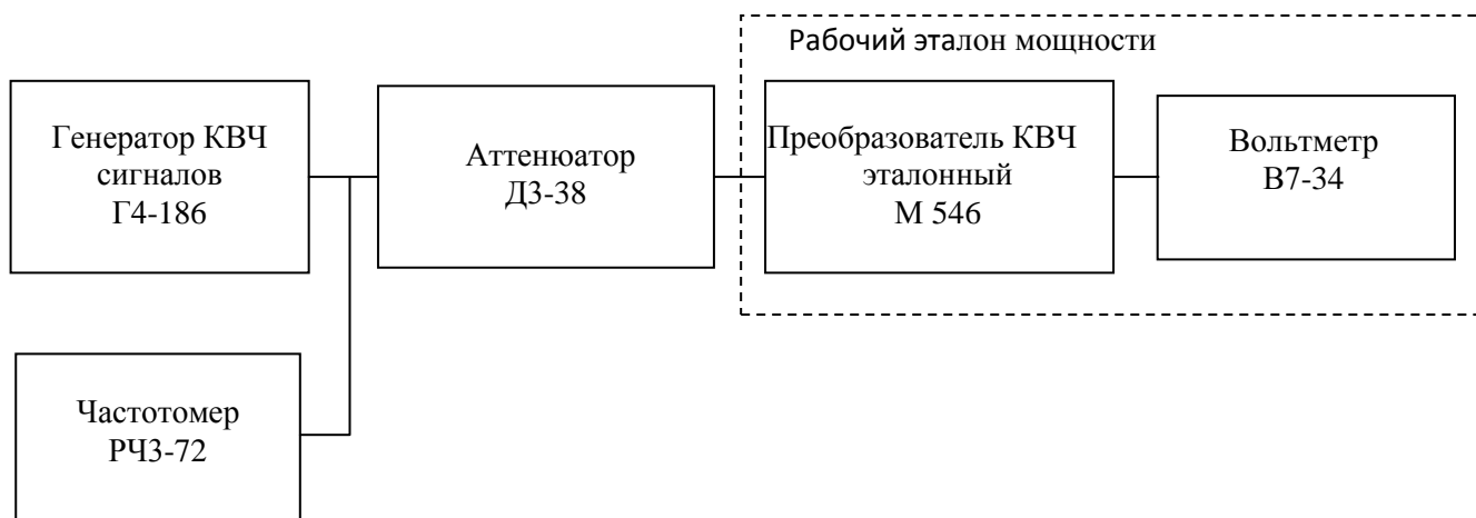
Рисунок 46 – Схема соединения приборов для определения основной погрешности ваттметра в диапазоне частот от 53,57 до 78,33 ГГц
