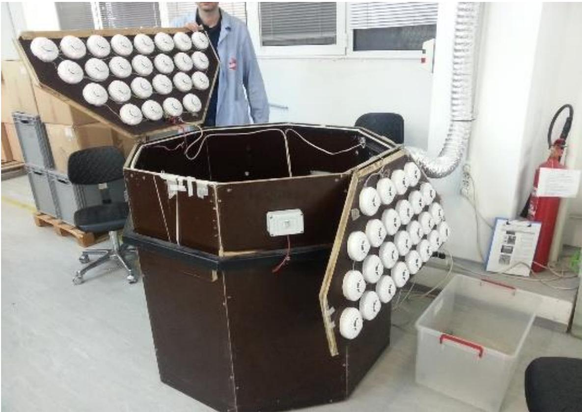
Рисунок 2. Камера для проверки дымных датчиков
