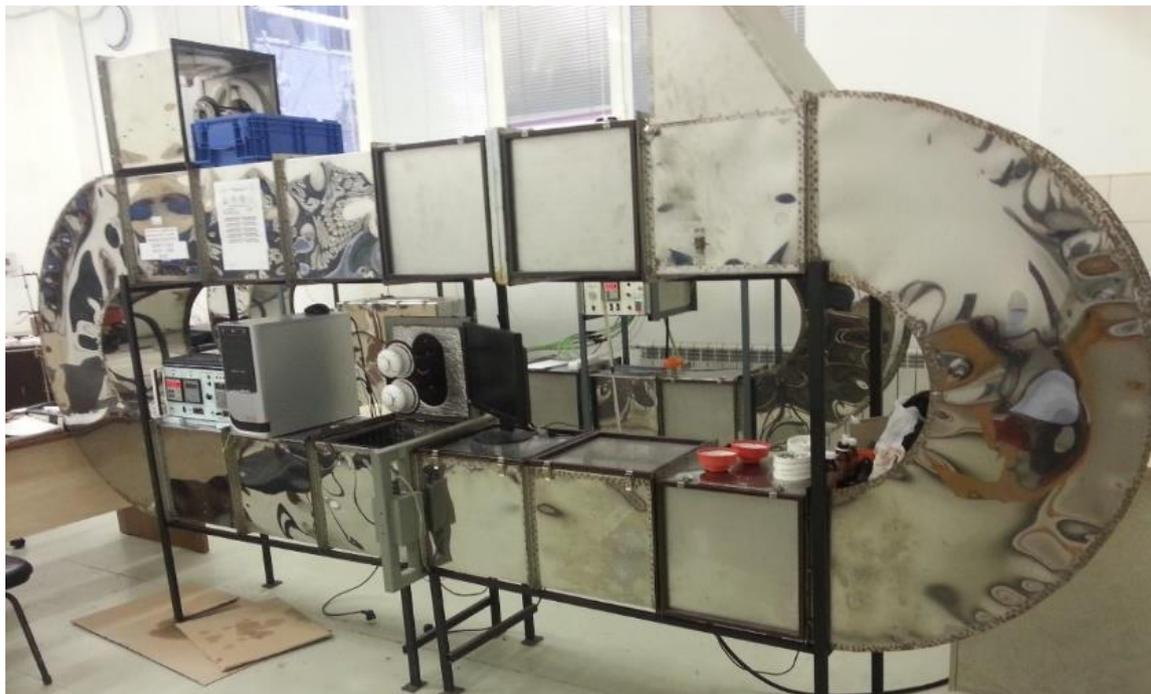
Рисунок 6. Установка для контроля чувствительности точечных дымовых извещателей
