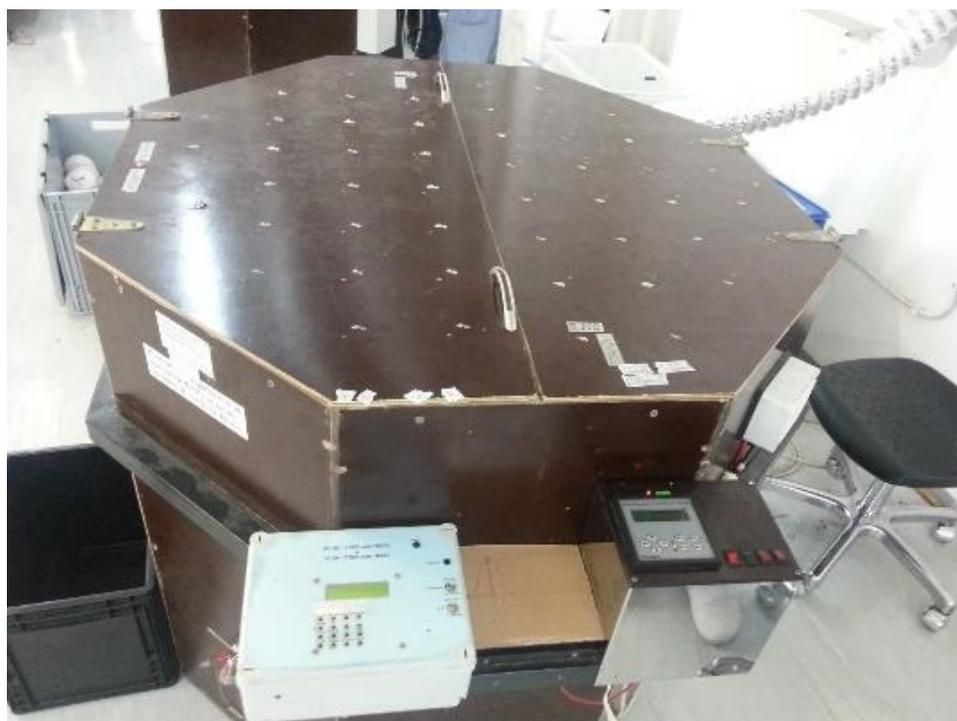
Рисунок 3. Камера для проверки дымных датчиков
