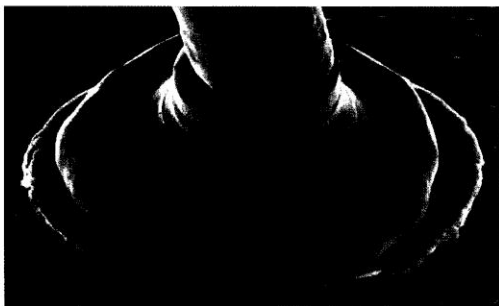
Рис.6. Пример выдавливания Al металлизации медным шариком
