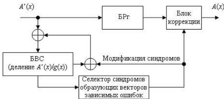
Рис. 2. Декодер БЧХ-кода для коррекции одиночных зависимых ошибок с модификацией синдромов
