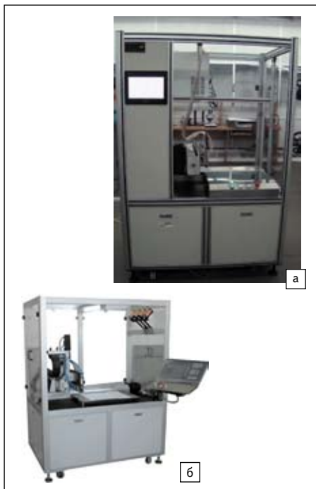
Рис. 3. Автоматические системы: а) посадки чипов; б) имплантации антенны
