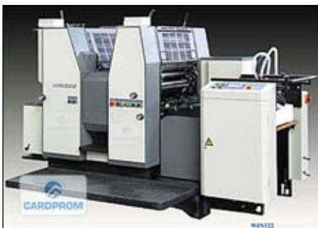
Рис. 5. Офсетная двухкрасочная листовая машина WIN 522
