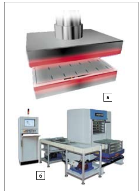
Рис. 4. а) Процесс ламинирования; б) полуавтоматическая система ламинирования
