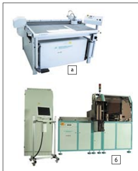
Рис. 8. Установки: а) резки листов ISC 500; б) вырубке карт CP 2021/М
