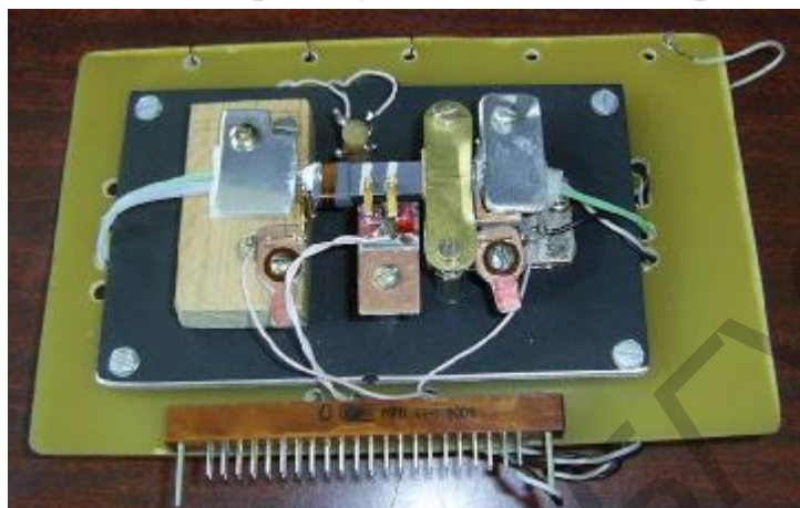
Рисунок 3.9 – Крепление образца Si и GaAs с нагревателем и крепление термопар для измерения температур концов образца
