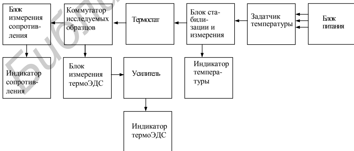
Рисунок 1.2 – Функциональная схема установки для измерения электрофизических параметров проводниковых материалов
