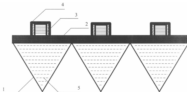
Полезная модель относится к устройствам антенной техники, в частности к устройствам для поглощения излучаемых антенной волн, и может быть использована при создании конструкций, экранирующих электромагнитное излучение (ЭМИ) и предназначенных для покрытия внутренних стен помещений, где располагается радиоэлектронное оборудование, а также для создания безэховых камер.
