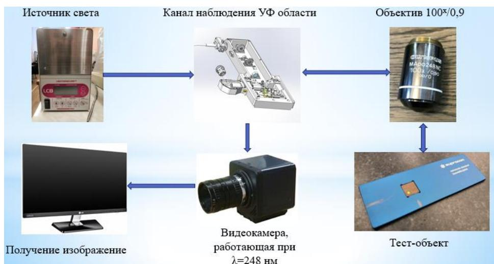
Рисунок 2 – Системообразующие элементы для исследования разрешающей способности ГУФ микроскопа
