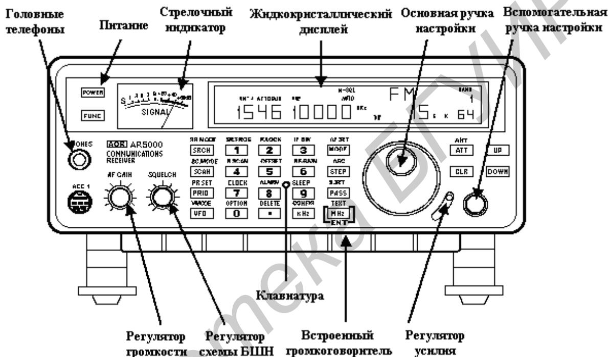
Рис. 9. Размещение органов управления приемником на передней панели
