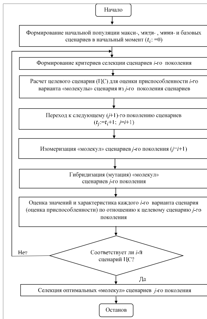
Рисунок 2. Универсальная блок-схема биоинспирированного квазимолекулярного алгоритма формирования оптимальных прогнозирования динамики вариационных рядов на основе изомеризации, гибридизации и селекции оптимальных вариантов («молекул») сценарных моделей
