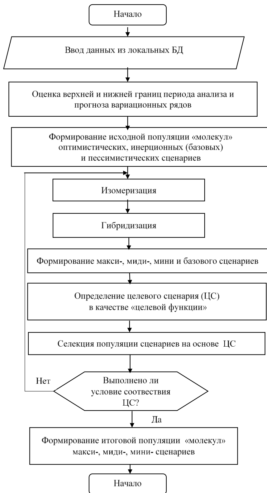
Рисунок 4. Блок-схема дедуктивного варианта биоинспирированного квазимолекулярного алгоритма формирования сценариев
