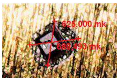
Рисунок 3 – Визуально-оптический контроль растекаемости припоя при монтаже кристалла
