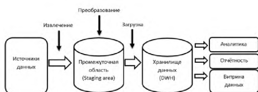
Рис. 1 – Процесс работы ETL-систем
