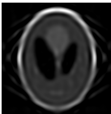
Рисунок 4.11 – Реконструкция фантома по 18 проекциям с помощью веерных лучей
