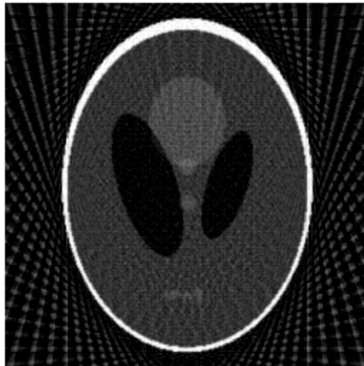
Рисунок 4.9 – Реконструкция фантома по 36 проекциям
