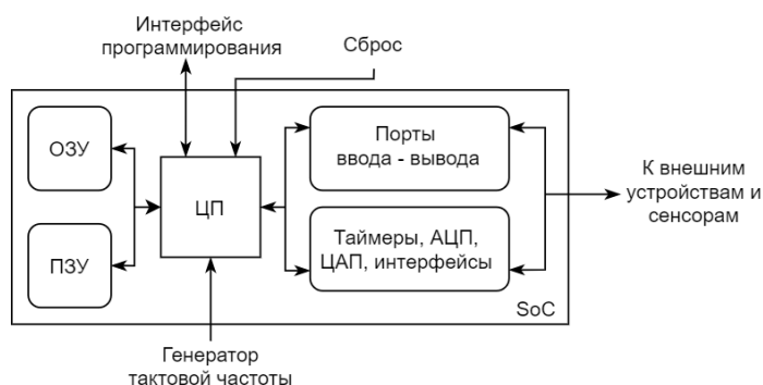
Рисунок 2 – Структура системы на кристалле
