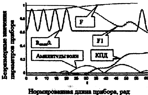
Рисунок 3 – Интегральные характеристики перестраиваемого по частоте гиротрона с двумя фильтрами
