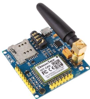
Рисунок 6. Модуль GPRS
