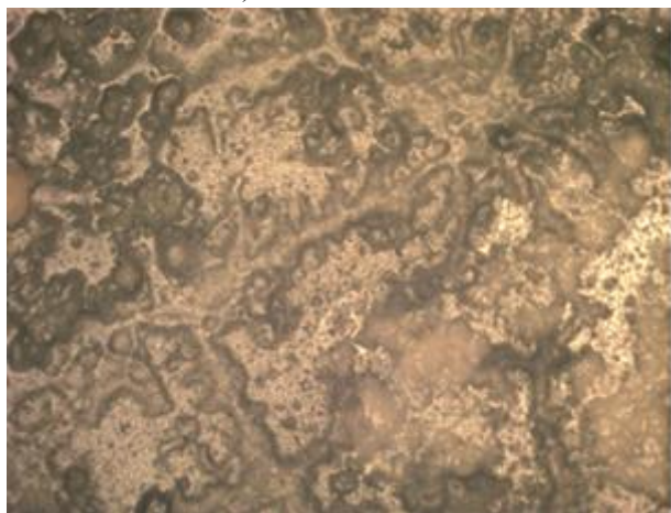
в) покрытие с содержанием \gamma - C_3N_4 10 масс%
