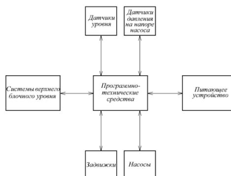
Рисунок 1 – Структурная схема системы подачи аммиака в теплоноситель
