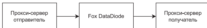
Рис. 3. Схема работы системы Fox DataDiode Fig. 3. Scheme of Fox DataDiode system the operation
