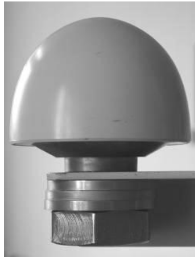
Рис. 3.15. Внешний вид антенны А5 на скобе антенной стойки
