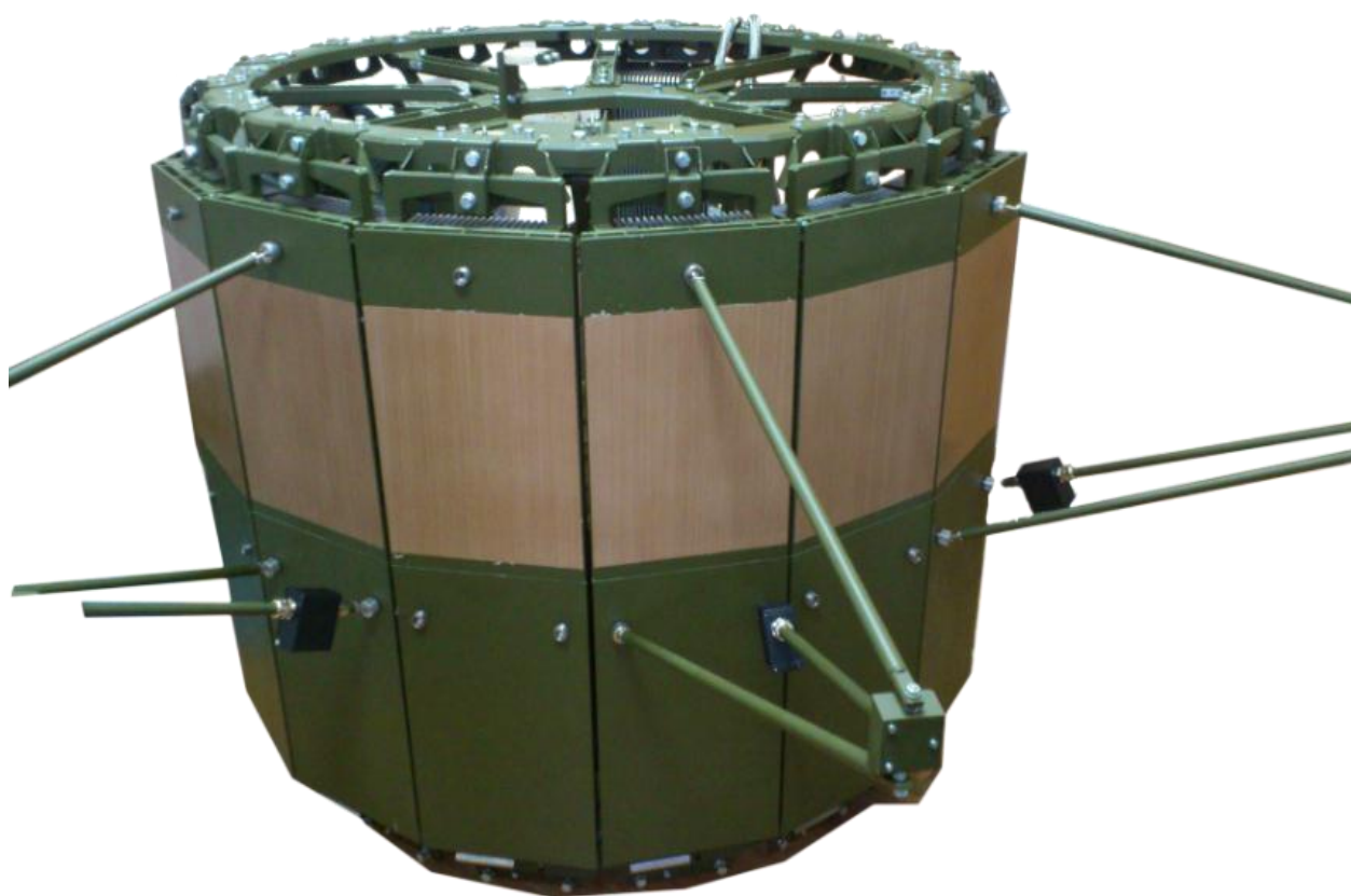
Рис. 3.25. Внешний вид граней ФАР, участвующих в формировании передающих и приемных лучей
