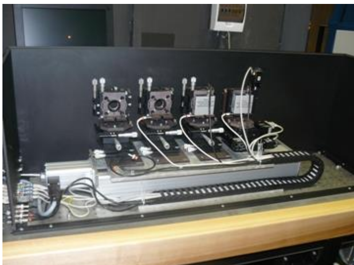
Рисунок 4.2 – Внешний вид эталона единицы спектральной чувствительности приемников излучения
