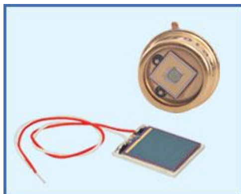
Рисунок 2.9 – Внешний вид приемной площадки фотодиодного датчика (производитель Thorlabs)
