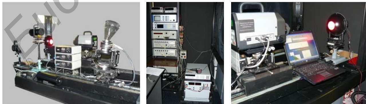
Рисунок 4.1 – Внешний вид Национального эталона единиц силы света и освещенности
