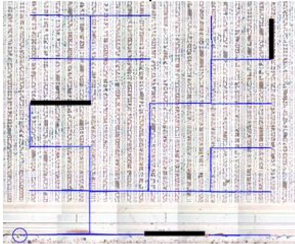
Рис. 4. Результат коррекции расположения кадров и полный маршрут сшивки, жирным отмечены пути с дополнительной обратнoй корректировкой
