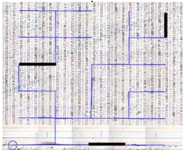
Рис. 4. Результат коррекции расположения кадров и полный маршрут сшивки, жирным отмечены пути с дополнительной обратной корректировкой
