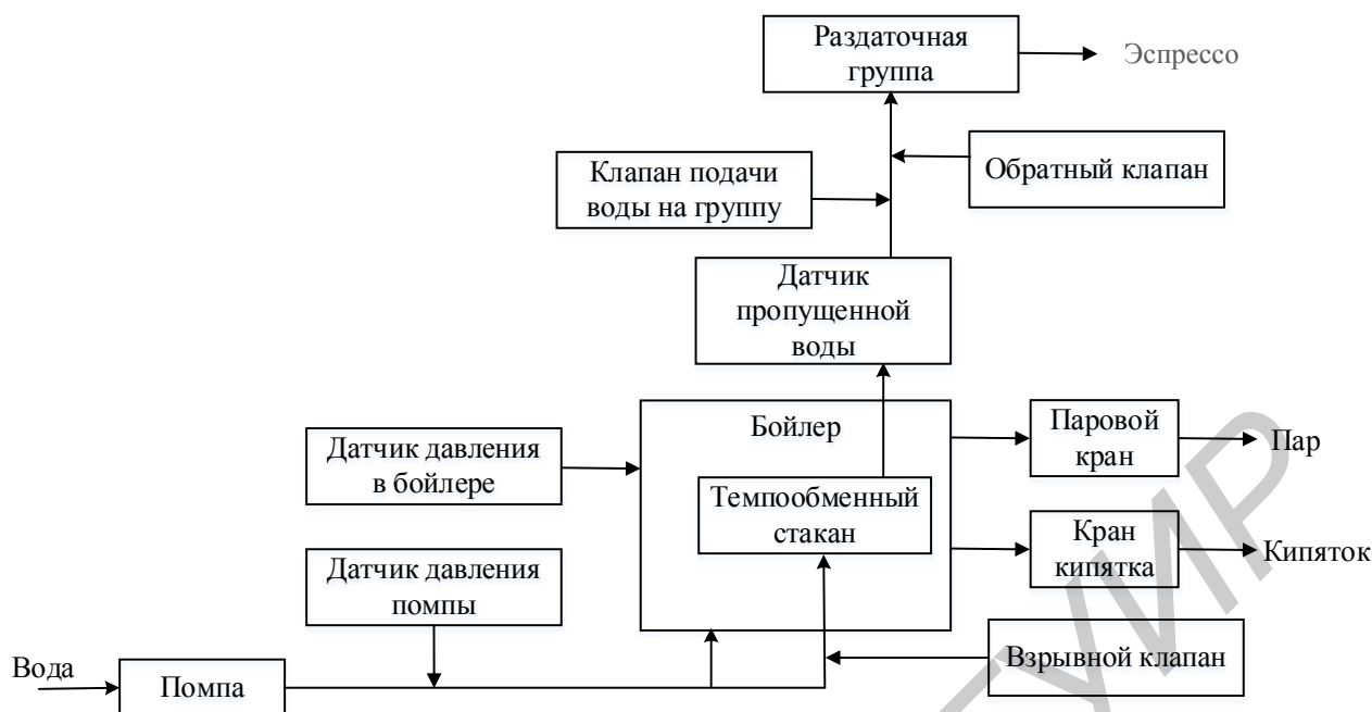
Рисунок 4.4 – Структурная схема системы «кофемашина»
