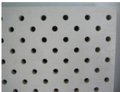
Рис. 4.17. Внешний вид фрагмента перфорированной плиты СМЛ-ППГЗ
