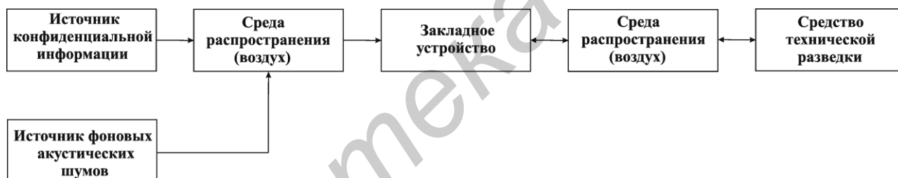
Рис. 3.14. Структурная схема параметрического канала утечки информации
