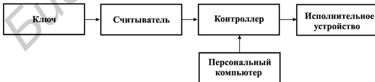
Рис. 6.29. Структурная схема СКУД
