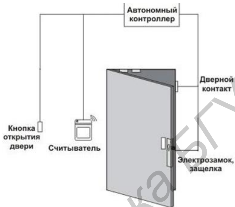
Рис. 6.30. Структурная схема автономной СКУД
