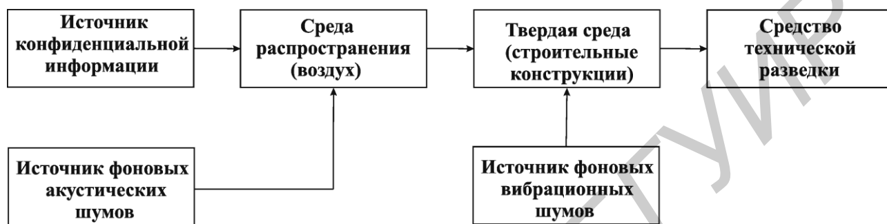
Рис. 3.6. Структурная схема виброакустического канала утечки информации
