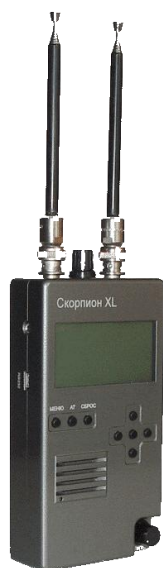
Рис. 5.11. Внешний вид сканирующего приемника «Скорпион-XL»
