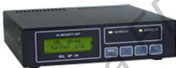
Рис. 5.4. Внешний вид устройства линейного зашумления «SEL SP-44»
