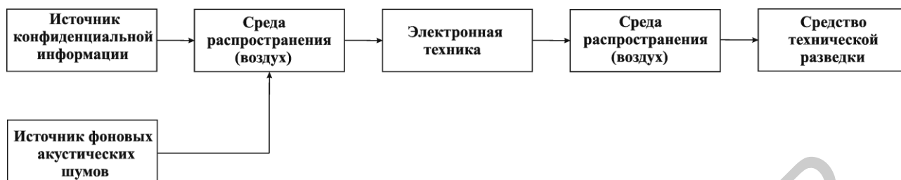
Рис. 3.13. Структурная схема параметрического канала утечки информации
