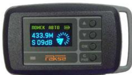
Рис. 5.8. Внешний вид индикатора-частотомера «Raksa-120»
