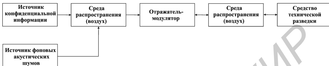
Рис. 3.10. Структурная схема акустооптического канала утечки информации
