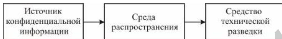
Рис. 1. Технический канал утечки информации
