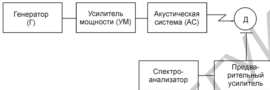
Рис. 1.7. Состав измерительной установки при контроле выполнения норм защищенности речевой информации с использованием спектроанализатора
