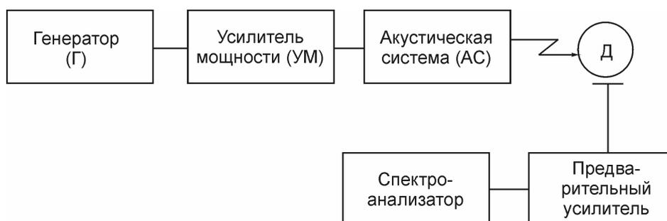
Рис. 2.4. Состав измерительной установки при контроле выполнения норм защищенности речевой информации с использованием спектроанализатора
