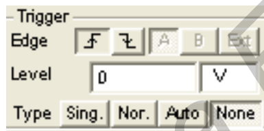
Рисунок А.8 – Блок запуска ждущей развертки в рабочем окне осциллографа
