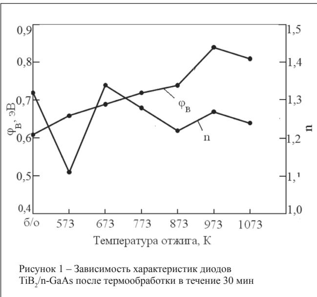
Рисунок 1 – Зависимость характеристик диодов  $\text{TiB}_2/\text{n-GaAs}$  после термообработки в течение 30 мин
